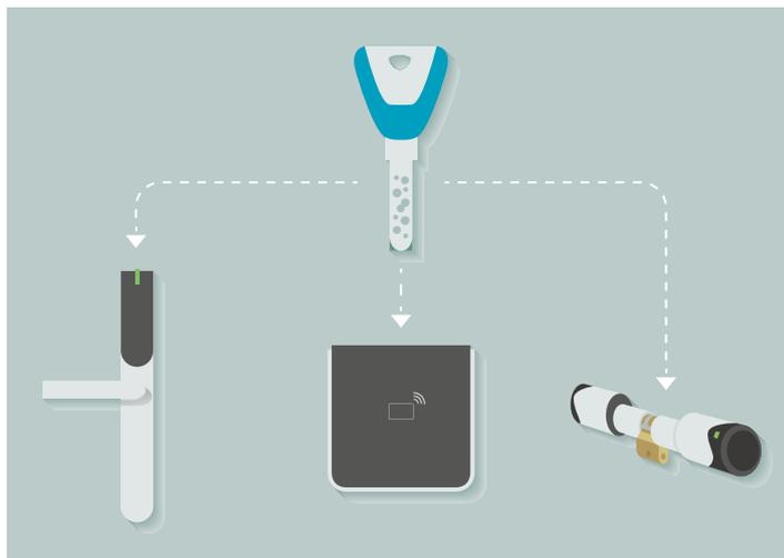
KESO-8000 $\Omega^2$ -Schließanlagen sind kompatibel mit mechatronischen und elektronischen Komponenten der KESO-Integra-Plattform. Mittels eines 2nd RFID Transponder im Schlüssel können auch andere Systeme wie z.B. die Zeiterfassung bedient werden.
